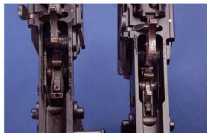
Geissele Abzüge im Vergleich: In dem DMR556 Griffstück (links) sitzt der justierbare "High-Speed"-Matchabzug mit sehr gut fühlbarem Druckpunkt, der nach Überwindung von 1.450 Gramm auslöst. Hierbei werden im Vorzugsweg schon 1.000 Gramm aufgebraucht, so dass für die Schussabgabe nur 450 Gramm übrig bleiben. In dem SBR556 Griffstück (rechts) sitzt der einfachere, nicht verstellbare "Super-Semi-Auto"-Abzug mit Gesamtabzugsgewicht von 2.380 Gramm und Auslösewiderstand von 700 Gramm.
