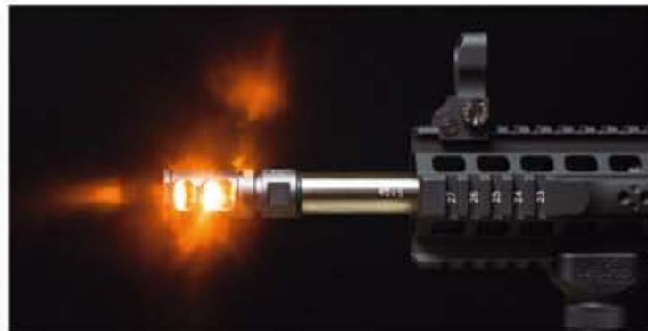
Der Gunworks THUMB Vault556 auf dem Oberland Arms OA-15 im Mündungsfeuertest.
