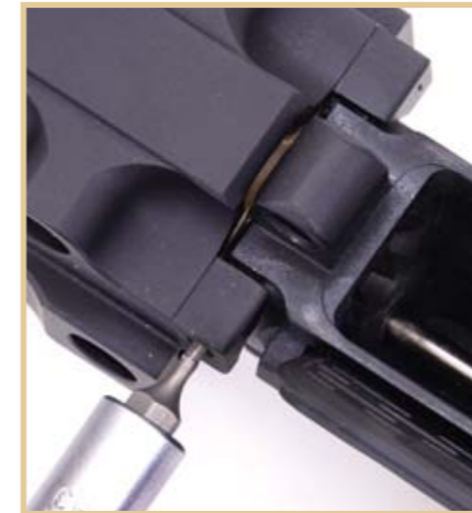
Toleranzausgleich am Geissele-Arms-Leichtmetallhandschutz.
